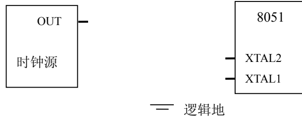
图 1-3 8051 外部时钟接入示意图
